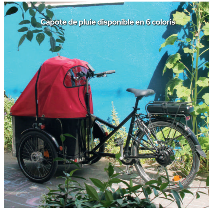
Moteur pédalier Shimano STEPS E6100 (couple maximal 70 Nm) avec batterie contre la malle
